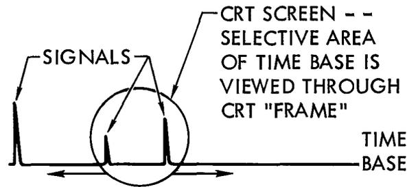
SWEEP DELAY CONTROLS THE POSITION OF THE CRT "FRAME" ALONG THE LENGTH OF THE TIME BASELINE.
