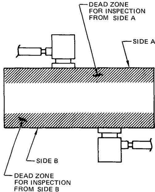
THE DEAD ZONE OF THE SIDE A INSPECTION IS COVERED BY THE SIDE B INSPECTION; THE DEAD ZONE OF THE SIDE B INSPECTION IS COVERED BY THE SIDE A INSPECTION.
